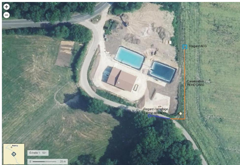
NB 1 : la canalisations en orange représente la canalisations de distribution que réalisera le Syndicat de Bayon Virecourt sous sa maîtrise d'ouvrage et à sa charge.
