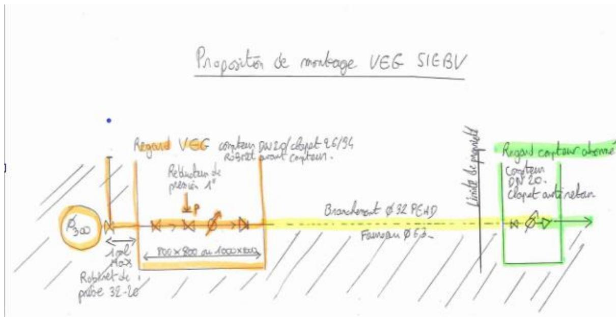
NB 1 : la partie surlignée en jaune représente la canalisations de distribution que réalisera le Syndicat de Bayon Virecourt sous sa maîtrise d'ouvrage et à sa charge.
